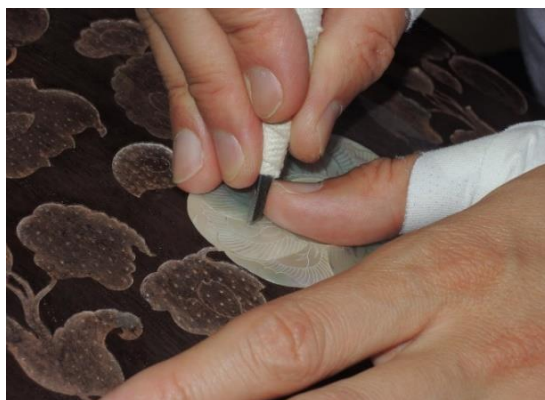
模造 螺鈿紫檀五絃琵琶の螺鈿に線彫りを施している様子
